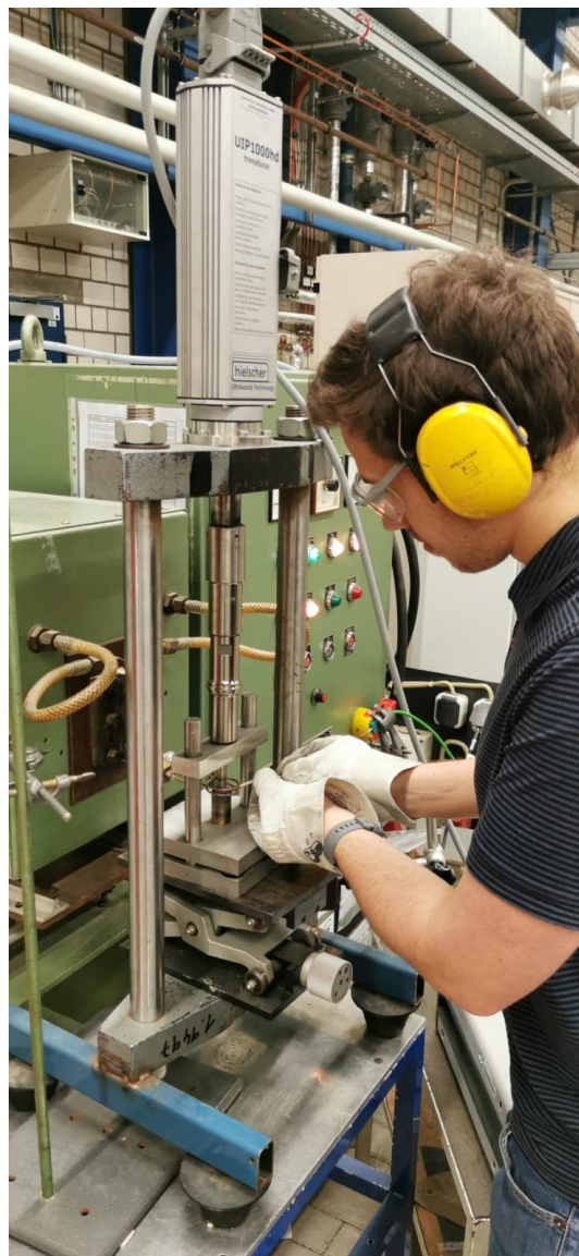
Henrik Ulitzka an der Induktionsanlage mit Ultraschalleinkopplung. Foto: RIF
