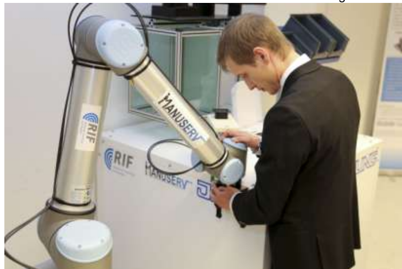
Für die neue Aufgabe vor der Laserbeschriftungskabine der Firma Jung wird der Roboter in kurzer Zeit manuell kalibriert.
