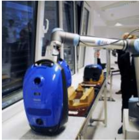
RIF-Labor Dortmund: Der Roboter nimmt den Staubsauger mit einem passiven Greifer vom Werkstückträger und stellt ihn auf dem Arbeitstisch ab.
