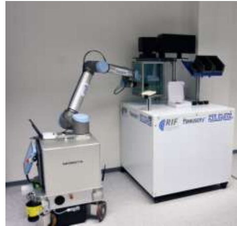
Derselbe Roboter fährt unterschiedliche Arbeitsplätze autonom an. Hier nimmt er das Netzteil der Firma Jung auf und platziert es exakt in der Laserbeschriftungskabine.
